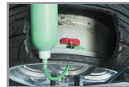
Slime Installation Test / Test d'installation Slime
